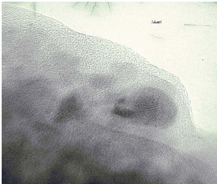
Fig. 3-49 TEM による \text{Mg}(\text{OH})_2 +薬剤コーティングの観察 (pH8)
