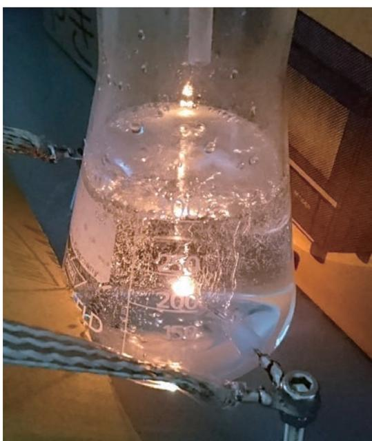
図 1 13.56MHz による液中プラズマ (RF 電力: 300W, 純水, 対向電極)
