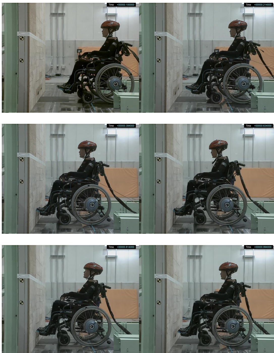
Fig.2-12 車椅子が壁に時速 6 km/h で衝突した場合 (ヘルメット有り) の様子
