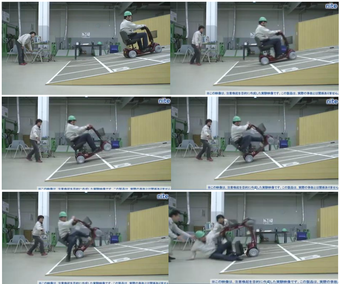
Fig.1-8 斜面からのハンドル型電動車椅子の転倒の様子 [20]
