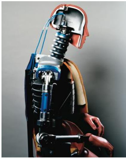
Fig.3-2 ダミーモデルの断面図 [2]
