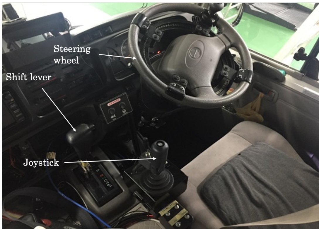
図 4-8. ジョイスティック式システムを実装した運転席
