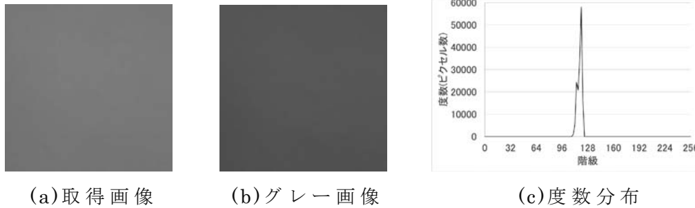
図 14 製品の塗装に関する状態監視(正常)
